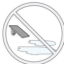
Nie instalować w miejscach narażonych na kontakt z wodą
