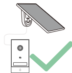
Zapewnienie, że kabel zasilający leży naturalnie bez napięcia
